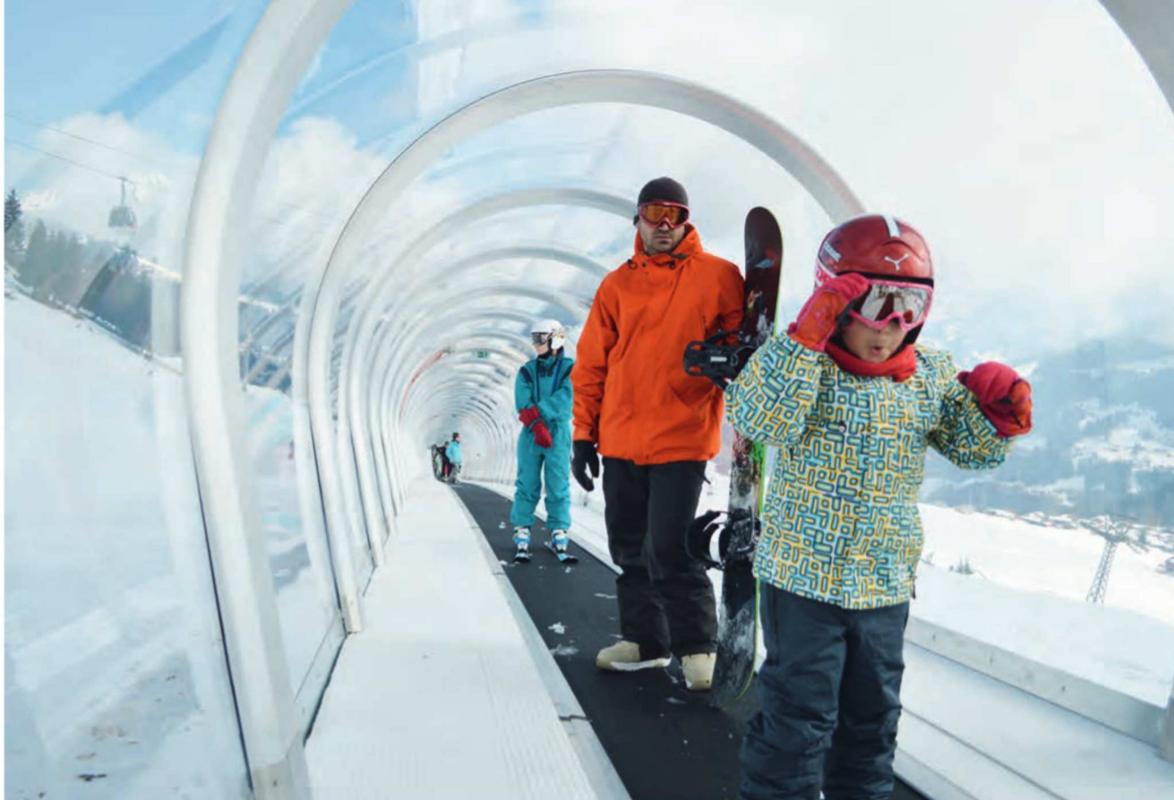
Der Bogen sorgt für eine gute Sicht und schützt gleichzeitig vor Regen und Schnee. Fotos: BORER LIFT AG
